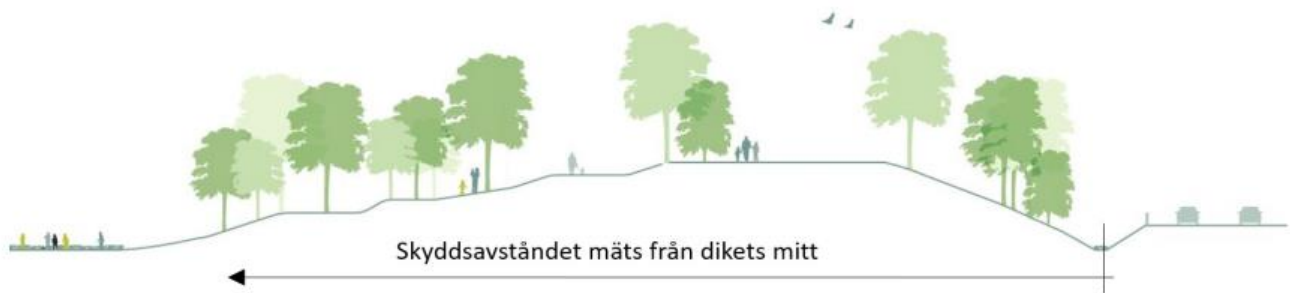
Figur 11. Illustration av hur angivet skyddsavstånd ska mätas då det finns dike (Länsstyrelsen i Norrbottens och Västerbottens län, 2019).
