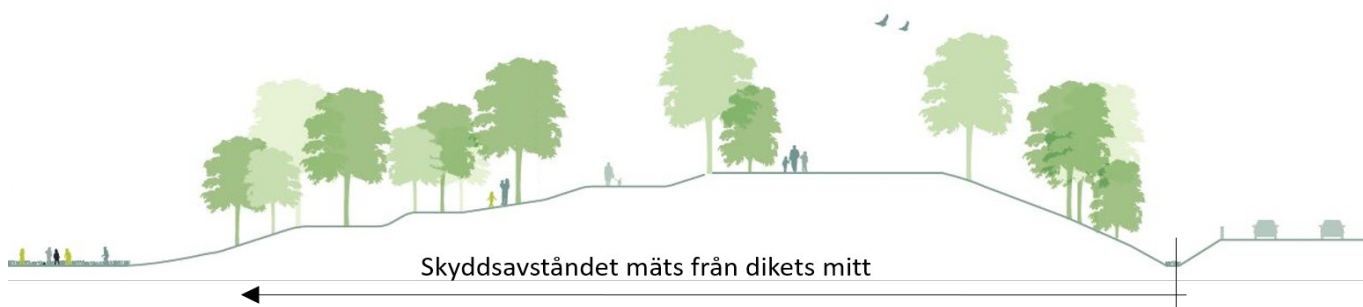
Figur 4. Illustration av hur angivet skyddsavstånd ska mätas då det finns dike.
