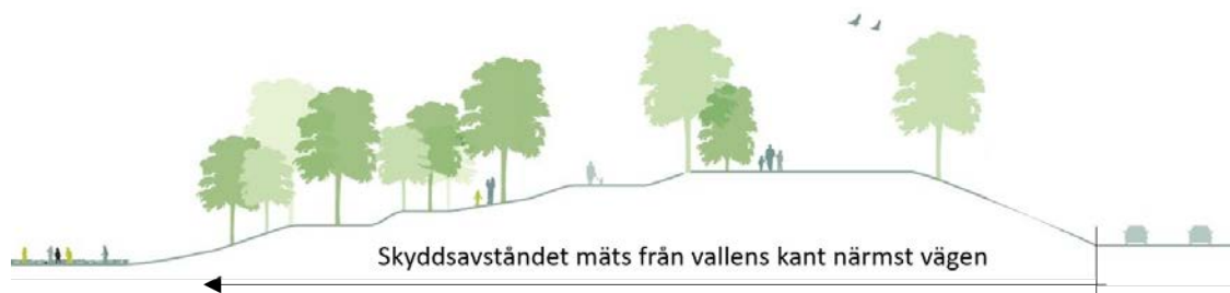
Figur 3. Illustration av hur angivet skyddsavstånd ska mätas då det finns en vall eller dylikt mot transportleden.
