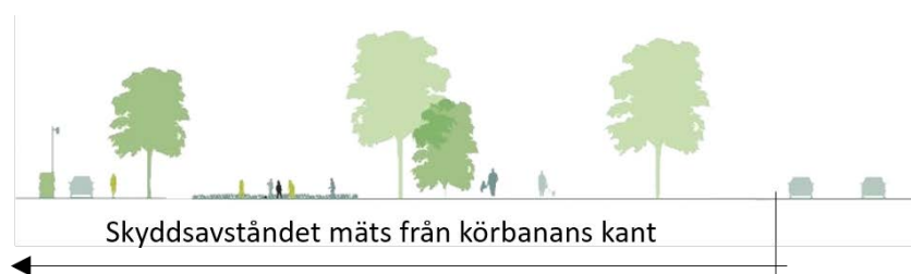
Figur 2. Illustration av hur angivet skyddsavstånd ska mätas med undantag då vall eller dylikt används. Vid järnväg gäller närmsta spårkant.
