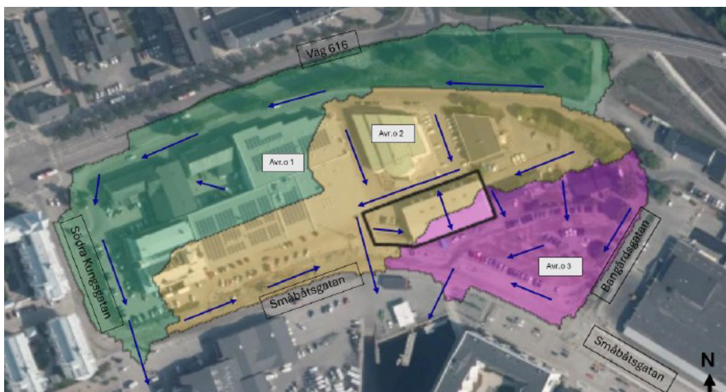
Bild 15. Avrinningsanalys för del av Stören 17, utförd i Scalgo Live. De tre identifierade avrinningsområdena visas som transparenta polygoner i grönt, orange och lila. Flödesvägar markeras med mörkblå pilar. Utredningsområdets avgränsning framgår som en svart polygon. Bildkälla: Ramboll
