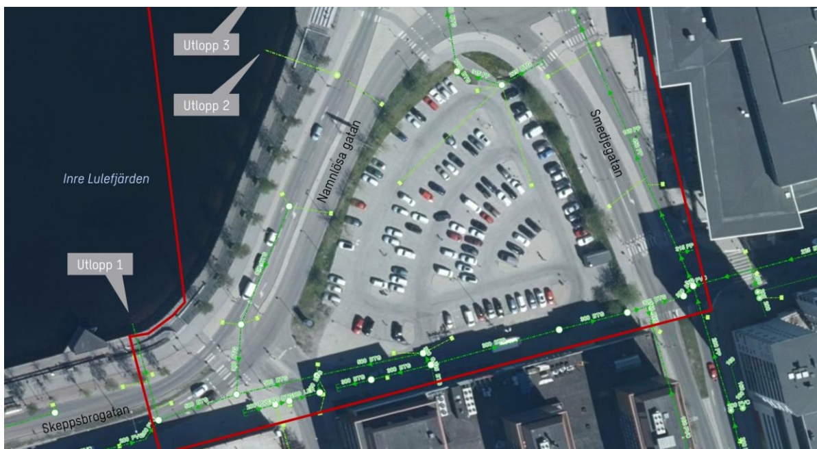
Figur 8. Dagvattenledningar inom planområdet, markerat i rött. Hela planområdet syns inte i bilden. Ljusgröna ledningar är ledningar inom fastighet/privata ledningar. Mörkgröna ledningar är VA-huvudmannens ledningar.
